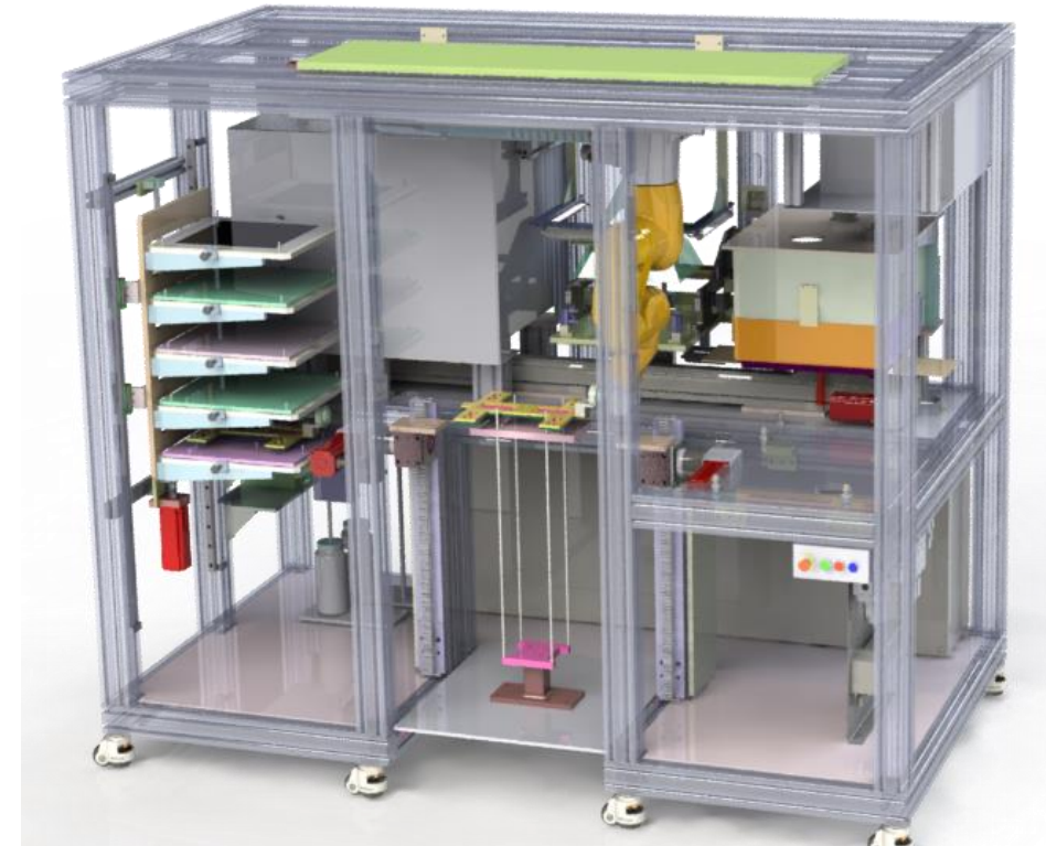
Ejemplo: PL5 – Línea piloto de fabricación automatizada de CCM (catalyst coated membranes) y montaje de pilas para electrólisis AEM
